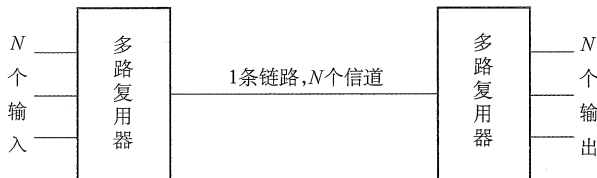
图 3.13 多路复用原理示意图
