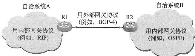
图 4.7 自治系统和内部网关协议、外部网关协议
