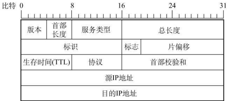
题 47d 图 IP 分组头结构
